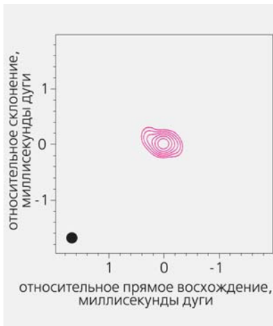
Рис.10. Радиоизображение области центра нашей Галактики с угловым разрешением 2 \cdot 10^{-4}'' , полученное на волне 3.5 мм методом радиоинтерферометрии со сверхдлинной базой [8]. Темное пятно в левом нижнем углу характеризует размер диаграммы направленности радиоинтерферометра. Видно, что центральная черная дыра массой 4 \cdot 10^6 M_{\odot} окружена оболочкой из плазмы, излучающей в радиодиапазоне, радиус которой составляет 1 а.е.
